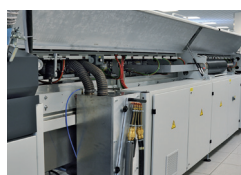
可在清洁冷凝管理系统的同时执行“在线”维护
